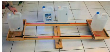
Nota : l'équilibre stable est impossible car le centre de gravité de l'ensemble mobile (fléau + bidons) se trouve au-dessus de l'axe du support. On obtient seulement un équilibre instable (basculement facile d'une position à l'autre).
